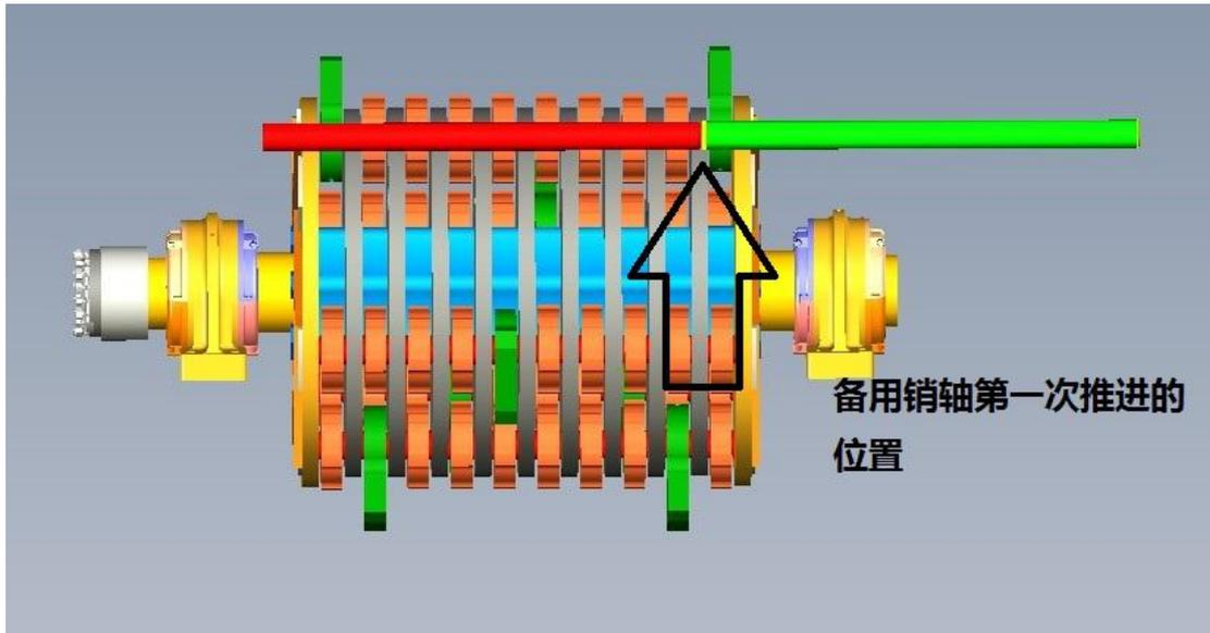
见上图，将备用销轴尾部的螺纹连接器连接好以后与拔销油缸头部插销使用销轴穿好，将备用轴推入转子，推过锤头一点后停止，见上图所示的位置，此时需要使用吊车将锤头带紧。
