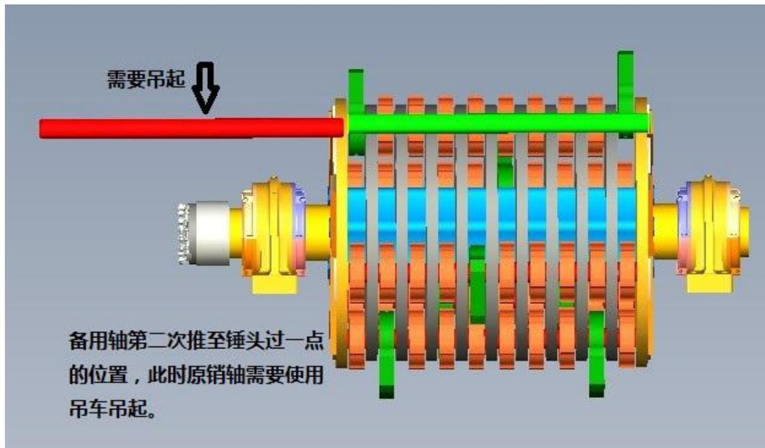
此时继续推销轴直到销轴端部超过锤头位置后停止，见上图，然后用吊车将锤头带紧，向后拉销轴。直到锤头可以完全取出时停止见下图
