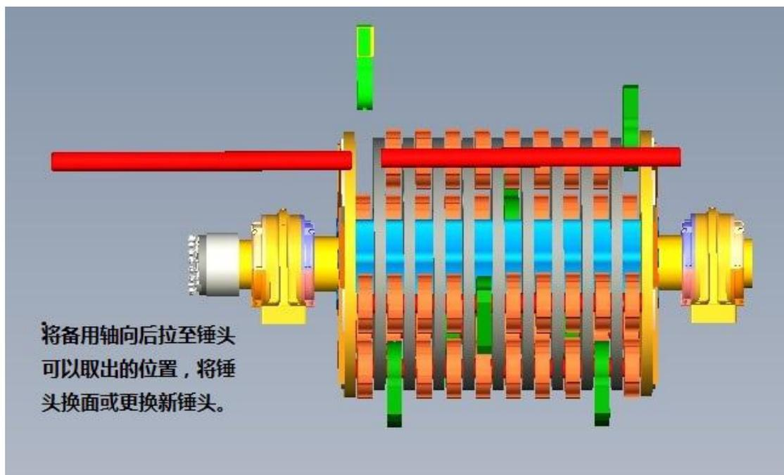
将锤头换面或更换新锤头后放置在原位置，并使用销控对准销轴，将销轴向前推。直到超过锤头位置后将吊车送掉用以吊退出的销轴。
