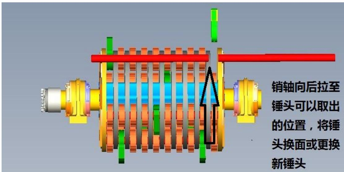
锤头用吊车吊住后，将备用轴向后慢慢拉出，直到锤头可以吊出时停止，注意不要拉出太多，否则销轴完全拉出转子后一头会落下造成危险，销轴的一头重量由转子承担。此时将锤头换面或更换一个新锤头并用吊车将翻好面或新锤头的孔对准销轴，再将销轴往前退，销轴推过锤头后将吊车松掉，锤头重量挂在销轴上。
