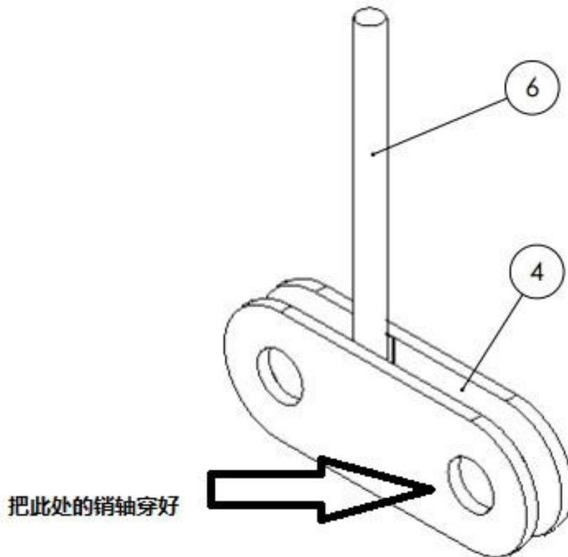
5、将破碎机转子进行旋转调整，使一个锤头销孔的位置对齐拔销油缸后使用楔铁将转子外侧圆盘与衬板之间塞紧，防止在推、拔销的过程中转子自己旋转，并且在转子圆盘两侧与破碎机侧墙之间也塞紧两块楔铁，以使用推拔销过程中油缸的力量直接传递至底座机体而不是轴承。
